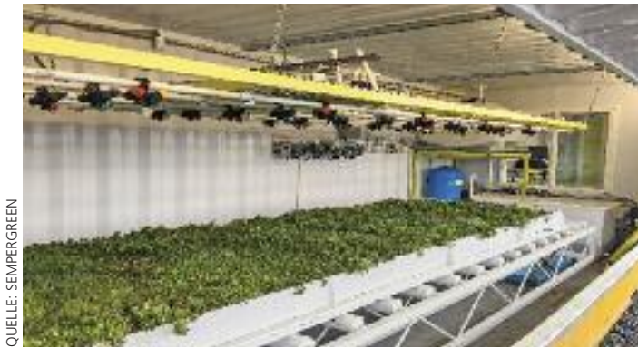
Untersuchungsaufbau zur Ermittlung von Wasserspeicherung und -abfluss.
