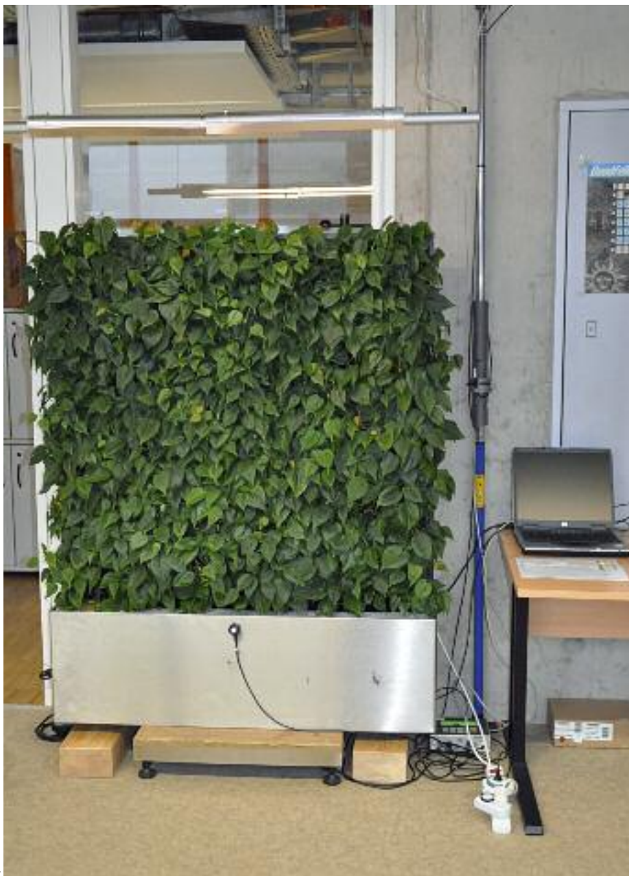
Abb. 4: Versuchsaufbau im großen Büro (33 m 2 ): System mit 1,4 m 2 Begrünungsfläche auf Waage, Raumklima-Fühler an der Baustütze und Zusatzbelichtung über dem System.
