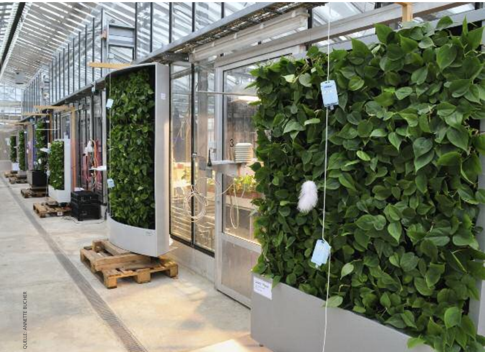
Abb. 1: Versuchsaufbau im Gewächshaus: Begrünungssysteme auf Waagen zur Erfassung der Wasserabgabe.
