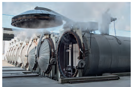
Bild 2. Produktion – Härtekessel (Quelle: Bundesverband Kalksandsteinindustrie e. V.)
